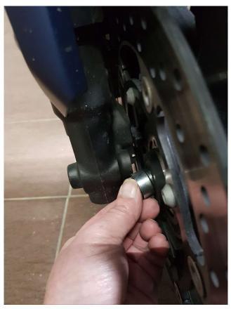
Sortir et remplacer le Rotor avec les chanfreins côté roue (Marquage « A » sur l'extérieur).
