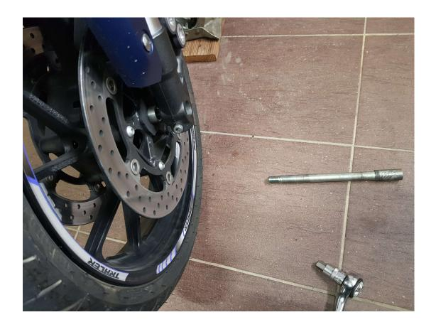
Tirer doucement la roue avant juste ce qu'il faut pour retirer la bague de à droite sans que les disques de frein ne sortent d'entre les plaquettes.
